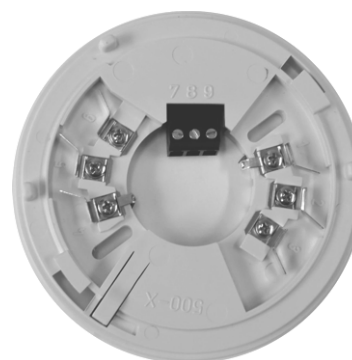
Fig 3: Relesokkel (7=Nc, 8=Com, 9=No)
